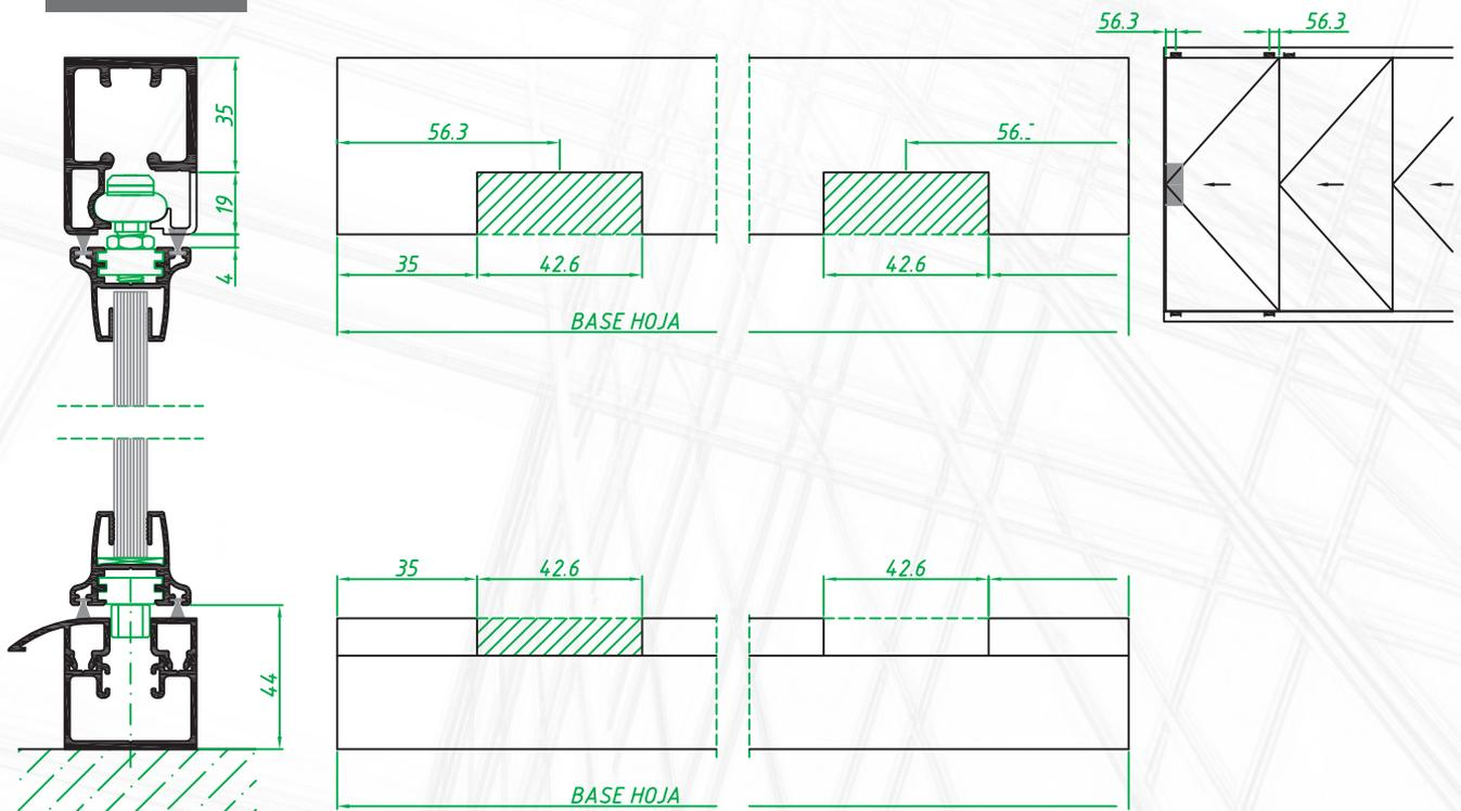
Mecanizado embocaduras superiores y corte complemento inferior interno con cerradura central
