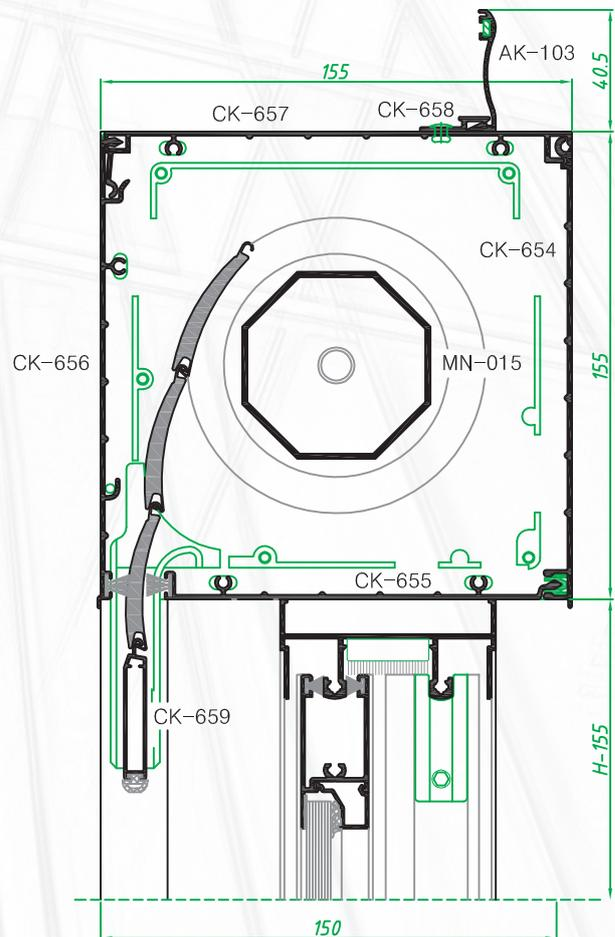
Encuentro vertical superior con eje de 62mm y caja de 155mm
